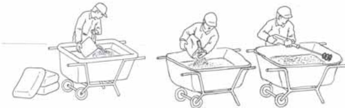
Figs. 16, 17 y 18 . Vertido del yeso sobre el agua y amasado mecánico.
