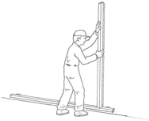
Figs. 6 y 7. Se aplica la pasta de yeso sobre las miras y se reciben las miras sobre la pared.
